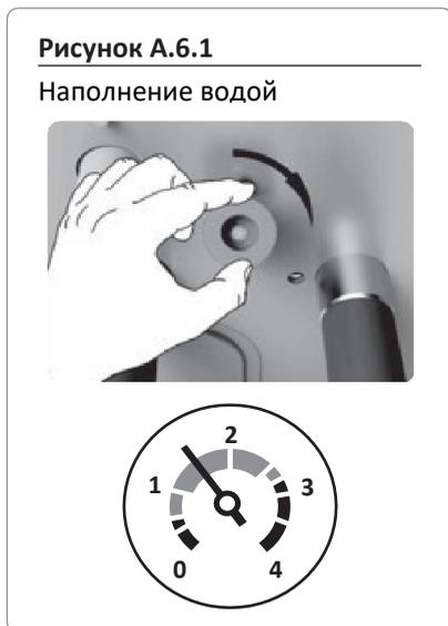
Устройство работает при давлении от 0,5 до 3,0 бар. Если давление воды падает ниже 0,5 бар, то изделие прекращает работу и выводит предупреждение на дисплей. Если давление воды превышает 3 бар, то происходит частичный слив воды из предохранительного клапана изделия. Данная ситуация не является неисправностью водоотвода и прекращается, когда давление воды падает ниже 3 бар. Давление воды можно увидеть как на дисплее, так и на манометре под изделием.
